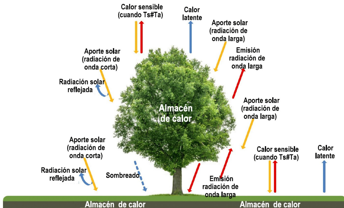
Figura 6. Balance energético de las infraestructuras verdes. Nota: las flechas representan fuentes de energía y pérdidas de energía. Las flechas naranjas son fuentes de energía hacia la infraestructura verde: radiación solar entrante (onda corta), radiación entrante de onda larga y ganancia de calor sensible (calor transferido cuando la temperatura del aire, T_a , es mayor que la temperatura de la superficie, T_s ). Ganancia de calor latente a través de la condensación de agua se supone ed para ser mínimo y no se muestra. Las flechas rojas son pérdidas de energía de la infraestructura verde que conducen a un aumento de la energía local. Temperaturas del aire: radiación de onda larga emitida y transferencia de calor sensible (cuando T_a es inferior a T_s ). Las flechas azules son pérdidas de energía de la infraestructura verde que pueden provocar una reducción de la temperatura del aire local: liberación de calor latente (evapotranspiración) y radiación solar reflejada. La flecha azul discontinua está sombreada, lo que contribuye a reducir las temperaturas de la superficie al reducir la cantidad de radiación.
